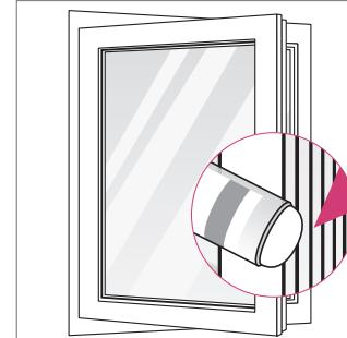
Pravidelně těsnění kontrolujte a pokud ho najeznete poškozené, je nutné toto vyměnit. Nové těsnění si objednejte u Vašeho dodavatele oken.
